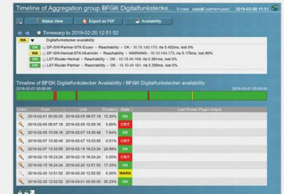
Abb. 2: Die Timeline stellt die Verfügbarkeit einzelner Funktionen übersichtlich dar. Auch nachträglich kann die Ursache für eine Störung ausgewertet werden.
