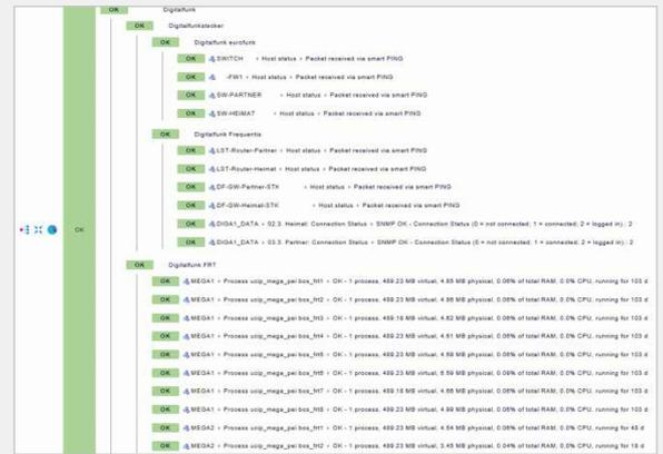
Abb. 2: Durch Aggregationen werden einzelne Überwachungen zu einer Gesamtfunktionalität zusammengefasst.
